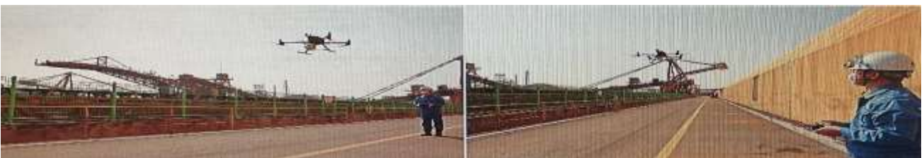
<Figure 6> 드론을 이용한 야드 광석재고 측정 시스템
